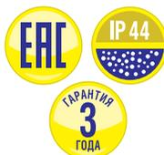
Электроустановка серии "ПЕГАС", со степенью защиты IP 44 отличное решение для эксплуатации в сырых, пыльных помещениях, ванных комнатах, автомойках, подвалах, гаражах, а также под навесами на открытом воздухе.
